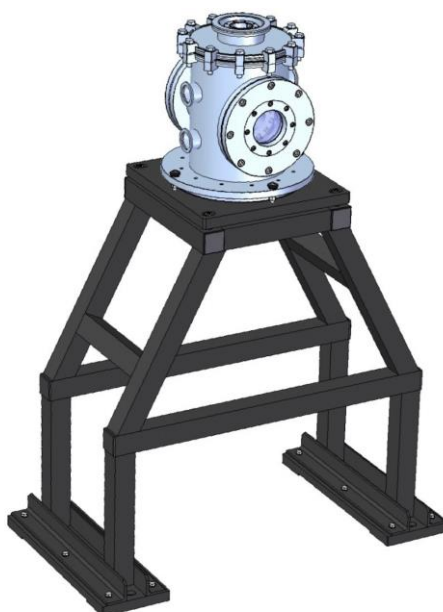
Obrázek 3. Laserová hlavice 10 J 10 Hz na podpůrném stojanu. Optická (laserová) osa systému je ve výšce cca 1.1 m.
