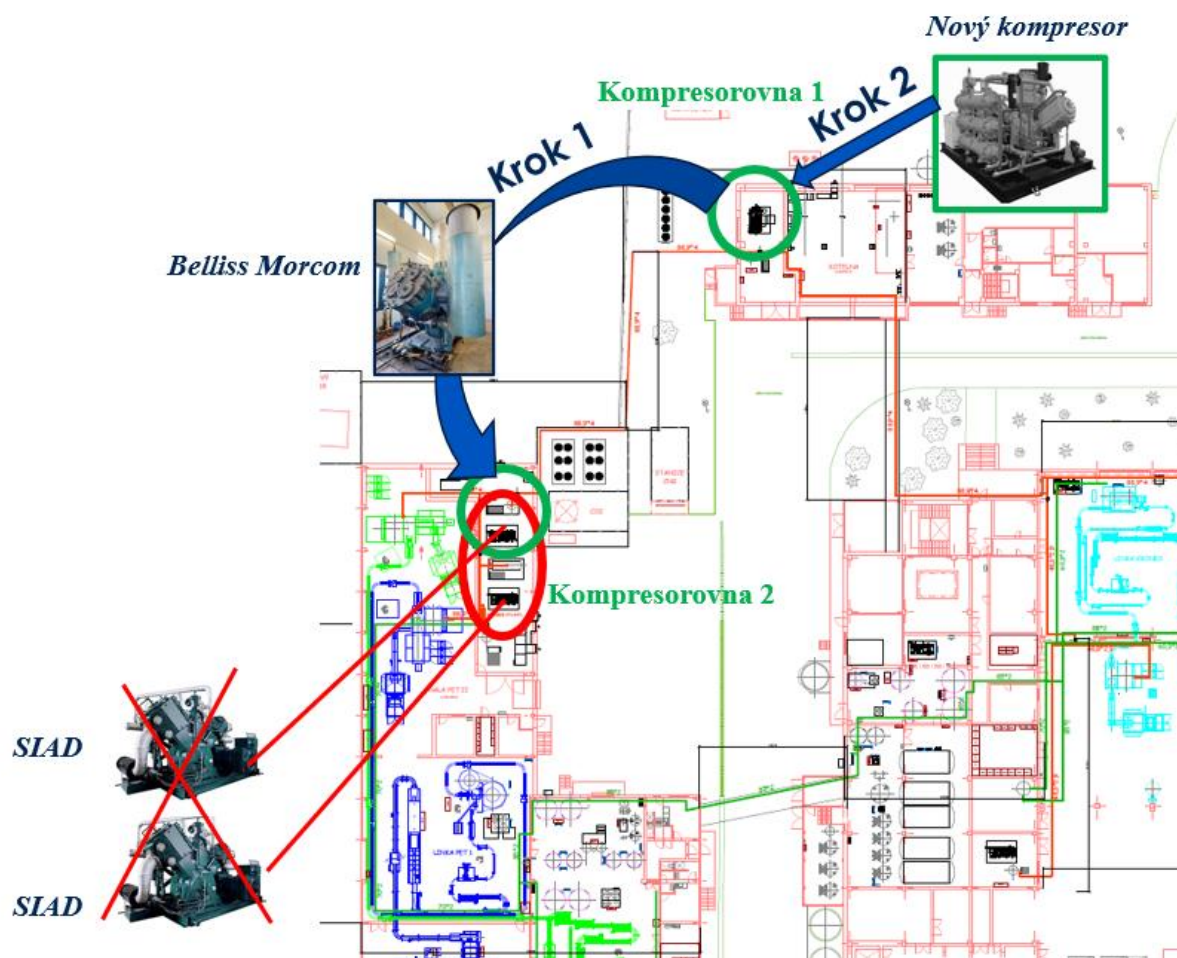
Obrázek 1 – schéma a postup instalace nového kompresoru
