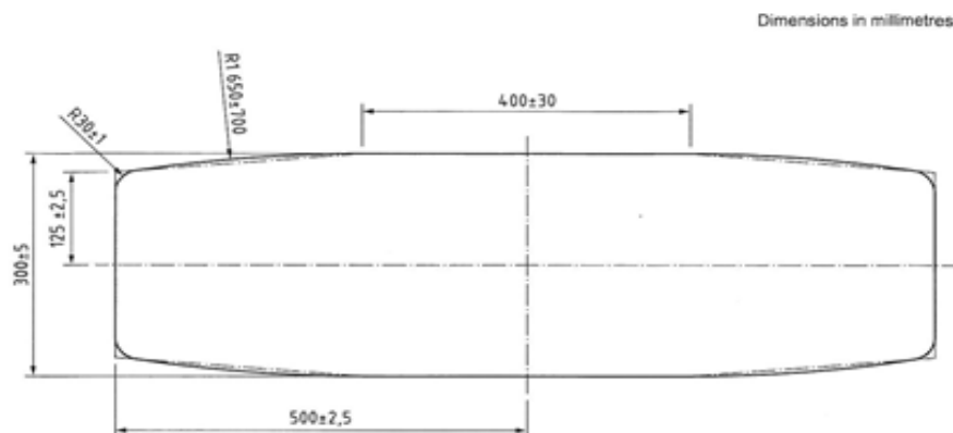
Obrázek 3 — Zařízení pro test trvanlivosti
