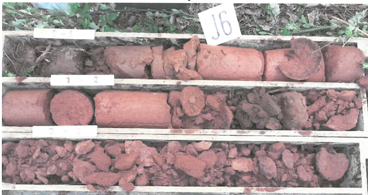
Fotodokumentace jádrového vrtu J6
