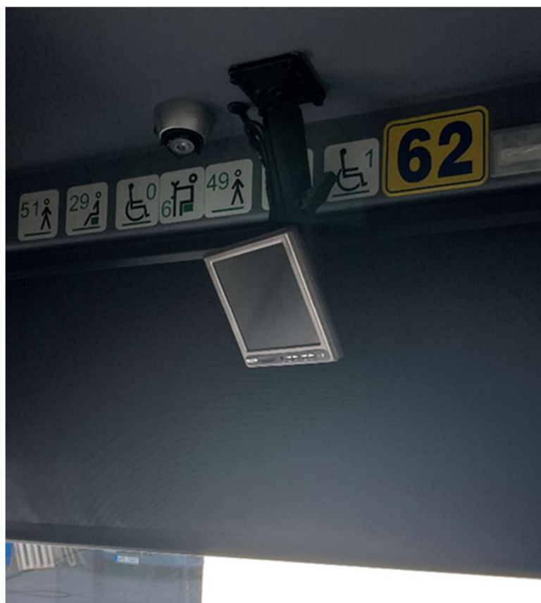
Obr. 3 umístění displeje kamerového systému
