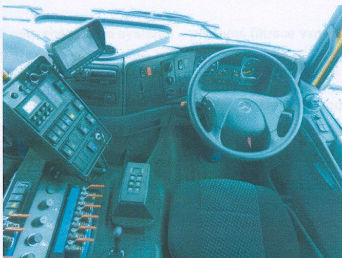
Pracoviště řidiče vozidla s 2-dílným ovládacím panelem nástavby Faun Viajet a monitorem kamerového systému
