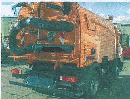
Ruční sací zařízení vzadu na nástavbě, výkavný výložník, hadice Ø 200 mm, délka 4.5 m
