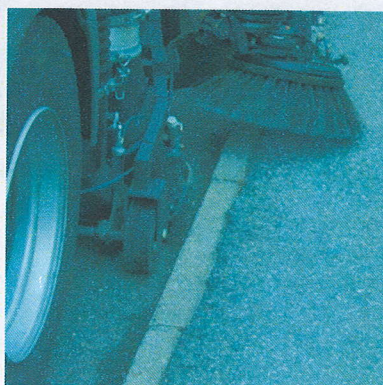
Teleskopické zavěšení krajního kartáče, možnost dvouúrovňového metení, z kabiny měnitelný sklon kartáče
