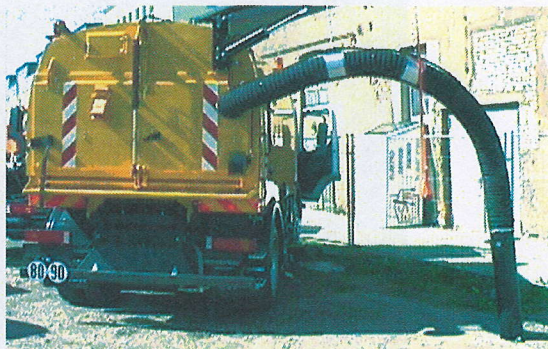
Ruční sací zařízení vzadu na nástavbě, výkavný výložník, hadice Ø 200 mm, délka 4.5 m
