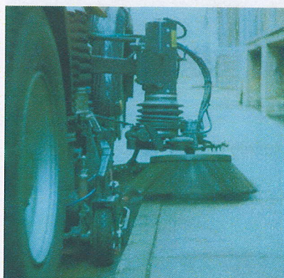
Teleskopické zavěšení krajního kartáče, možnost dvouúrovňového metení, z kabiny měnitelný sklon kartáče
