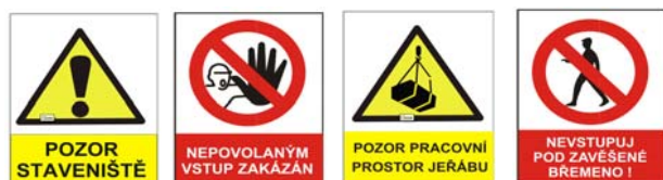
Obr.č.1: Bezpečnostní a informační označení u vstupů a vjezdů na staveniště
