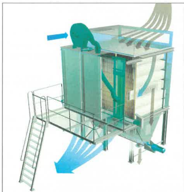
Obr. 2. Znáznornění proudění vzduchu
