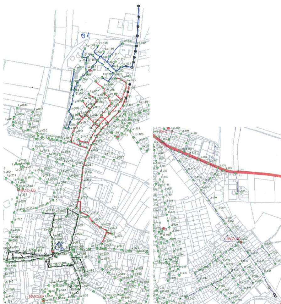
Obr. 2: Schematické znázornění zapojení světelných bodů na základě pasportu s doplněním, vlevo nahoře RVO1 a RVO2, vlevo dole RVO6, vpravo RVO20
