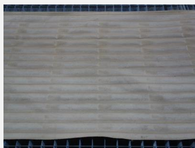
střední část FH (vnitřní strana) - silně znečištěna prachem
