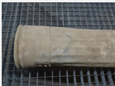
horní část FH (funkční strana) - silnější prach. koláč, lokální nálepy
