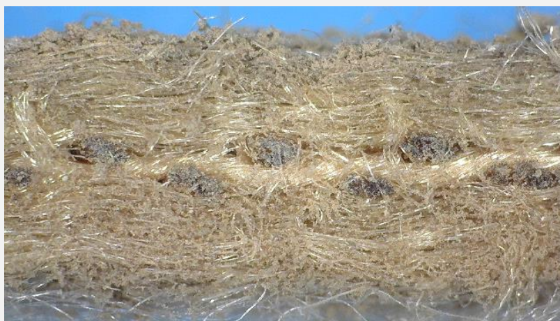
příčný řez filtračním médiem – horní část FH – intenzivní penetrace prachu do celé struktury filtračního média
