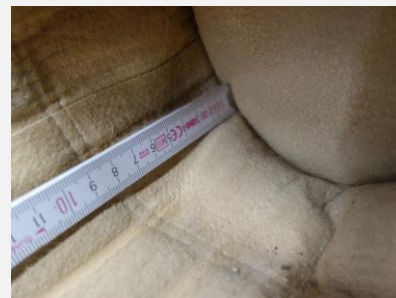
detail čisté strany FH v oblasti dna – vzdálenost dno koše – dno hadice je 40 mm
