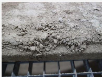
detail funkční strany FH – střední část – lokální prachové nálepy
