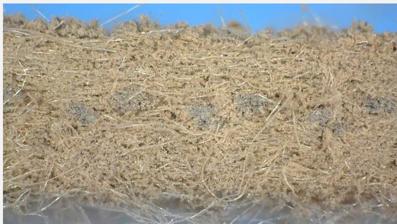
příčný řez filtračním médiem – spodní část FH – intenzivní penetrace prachu do celé struktury filtračního média
