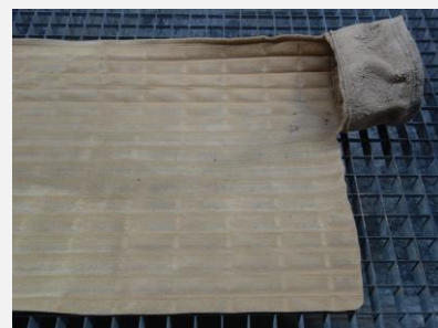
spodní část FH (vnitřní strana) - silně znečištěna prachem, hrubé zbytky
