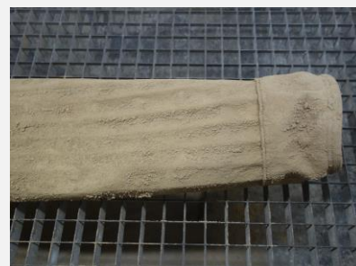
spodní část FH (funkční strana) - silnější prach. koláč, lokální nálepy
