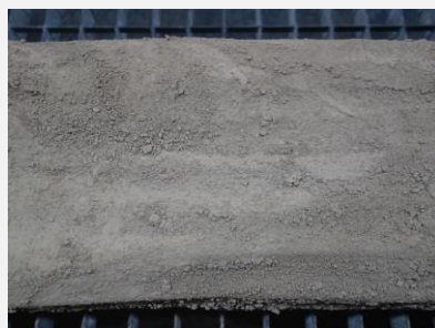
střední část FH (funkční strana) - silnější prach. koláč, lokální nálepy
