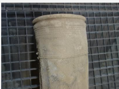
detail funkční strany FH – schnapring
