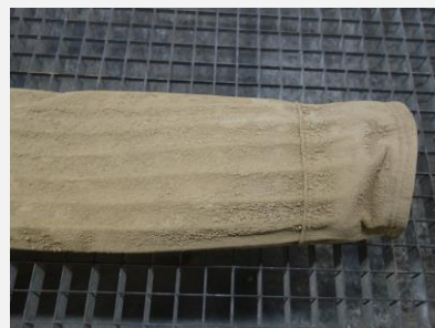
spodní část FH (funkční strana) – silnější prachový koláč
