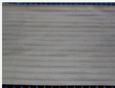
střední část FH (vnitřní strana) – silně znečištěna prachem
