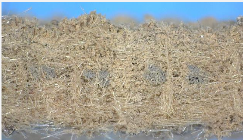
příčný řez filtračním médiem – dolní část FB – intenzivní penetrace prachu do celé struktury filtračního média
