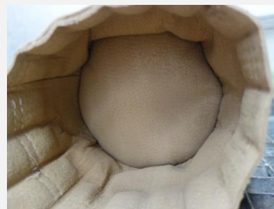
čistá strana FH v oblasti dna – znečištění prachem
