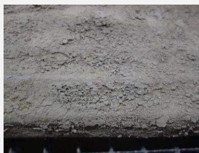
detail funkční strany ve střední části FH – silný prachový koláč s nálepy
