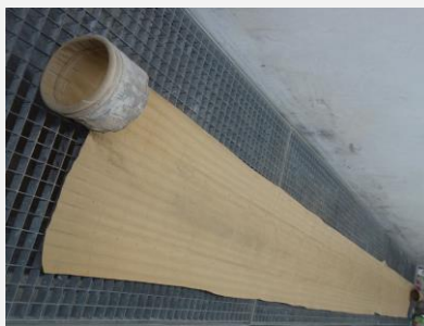
FH vnitřní strana (čistá strana) – silně znečištěna prachem
