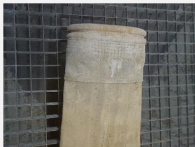
detail funkční strany FH v oblasti snapringu
