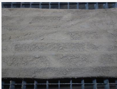
střední část FH (funkční strana) – silnější prach. koláč s lokál. nálepy
