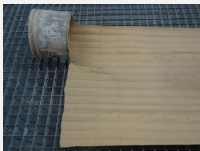
horní část FH (vnitřní strana) – silně znečištěna prachem
