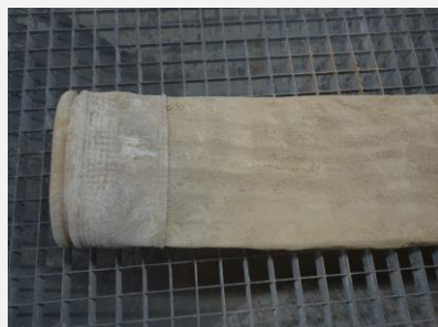
horní část FH (funkční strana) – silnější prachový koláč + lokální nálepy
