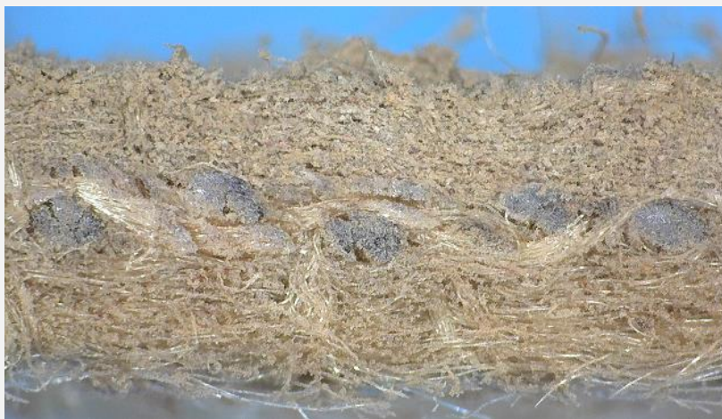
příčný řez filtračním médiem – horní část FB – intenzivní penetrace prachu do celé struktury filtračního média
