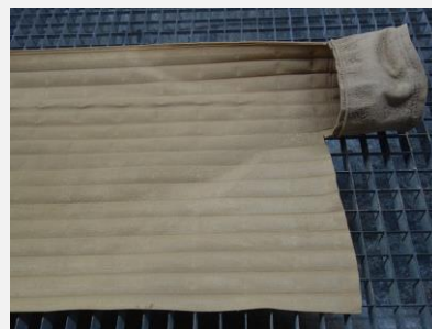
spodní část FH (vnitřní strana) – silně znečištěna prachem
