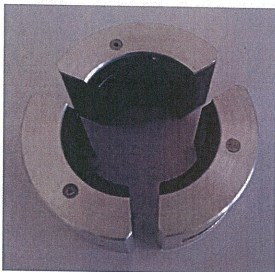
Obr. 4.7 Segmenty radiálního plynového ložiska
