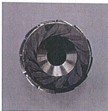
Obr. 4.4 Centripetální turbínové 3D kolo a lopatky rozvaděče
