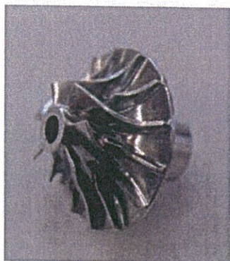
Obr. 4.4 Centripetální turbínové 3D kolo a lopatky rozvaděče
