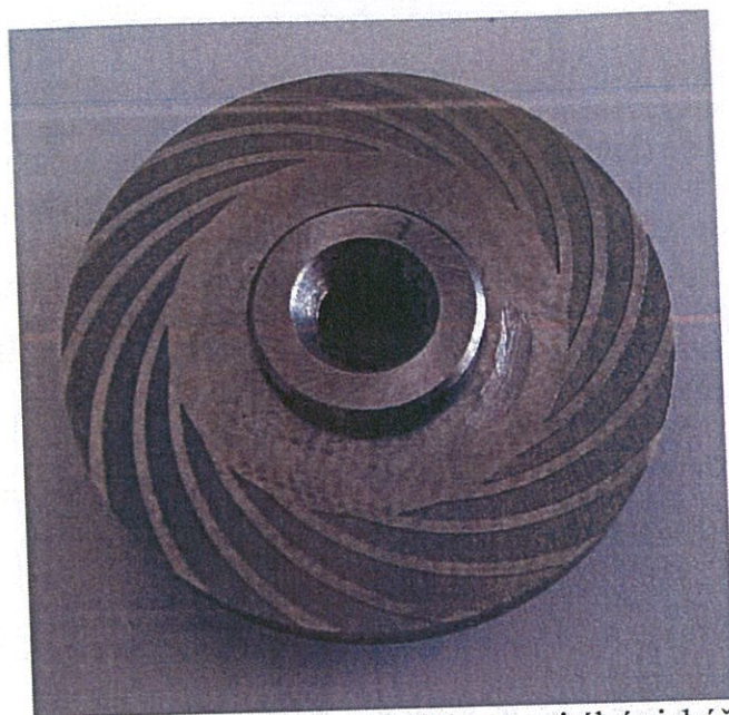
Obr. 4.8 Axiální plynové ložisko se spirálními drážkami
