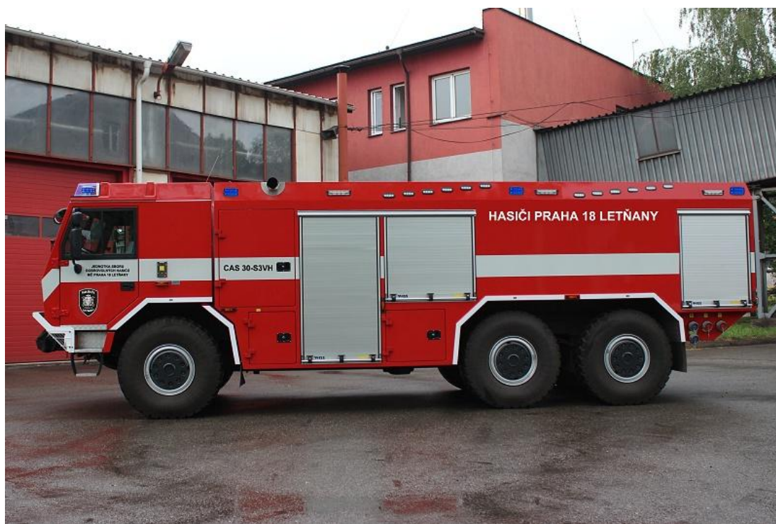
Obr. č. 1 – Koncepce nástavby, rozmístění pracovního osvětlení, světelných stavoznaků a světelného výstražného zařízení
