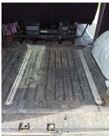
Možné řešení ližin pro umístění klienta na vozíku při přepravě v mikrobusu a detail ližiny.
