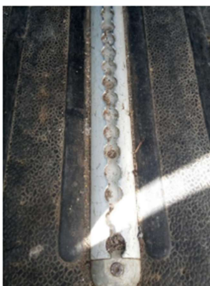
Možné řešení ližin pro umístění klienta na vozíku při přepravě v mikrobusu a detail ližiny.
