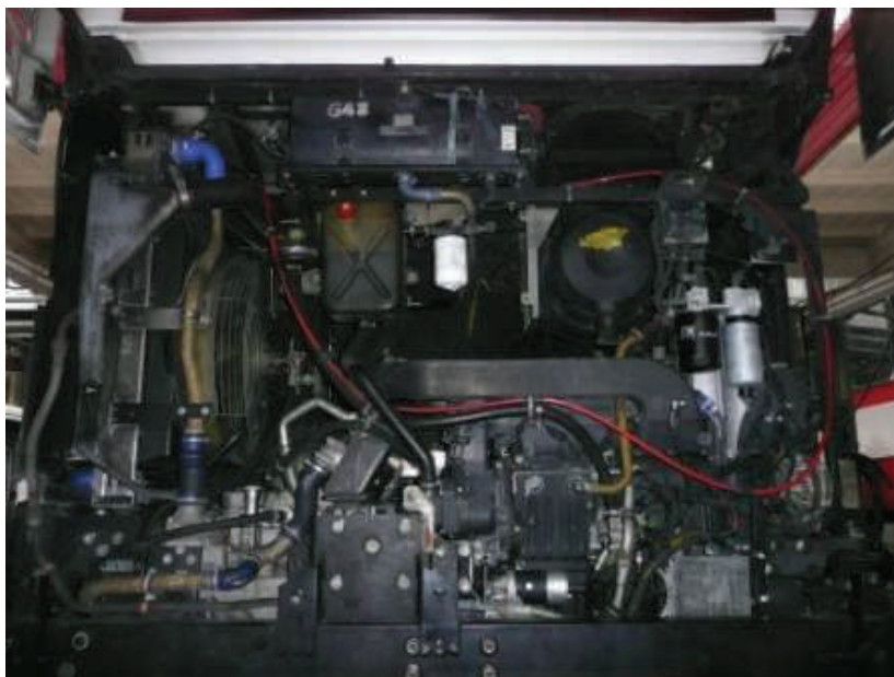
Obrázek 1: SHZ v motorovém prostoru autobusu, viz červená hadička
