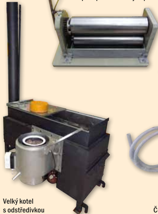
Hladké válce se stavitelnou roztečí pro úpravu voskových pásů
