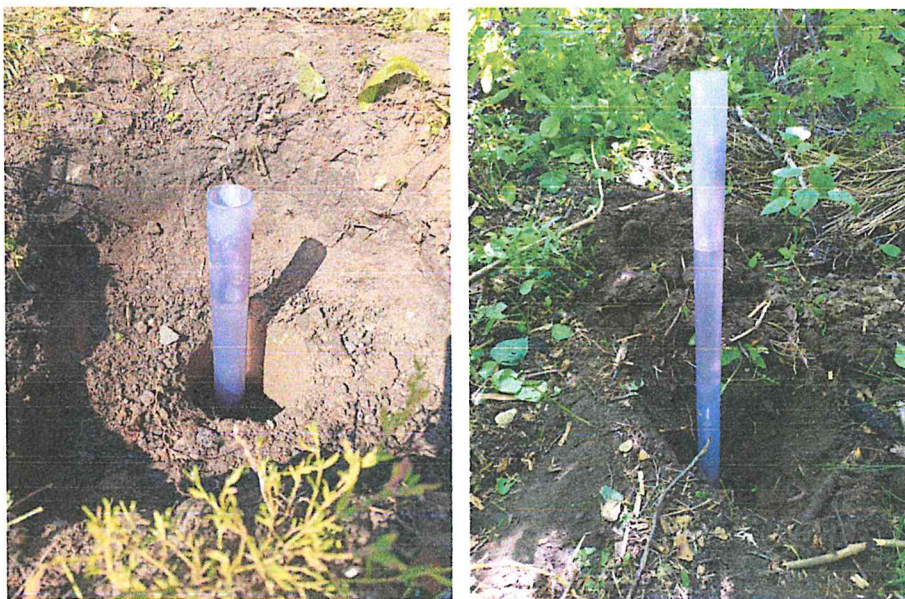
KLUK – VSAKOVACÍ ZKOUŠKY: VRTANÁ SONDA S-1 – VLEVO, SONDA S-2 – VPRAVO
