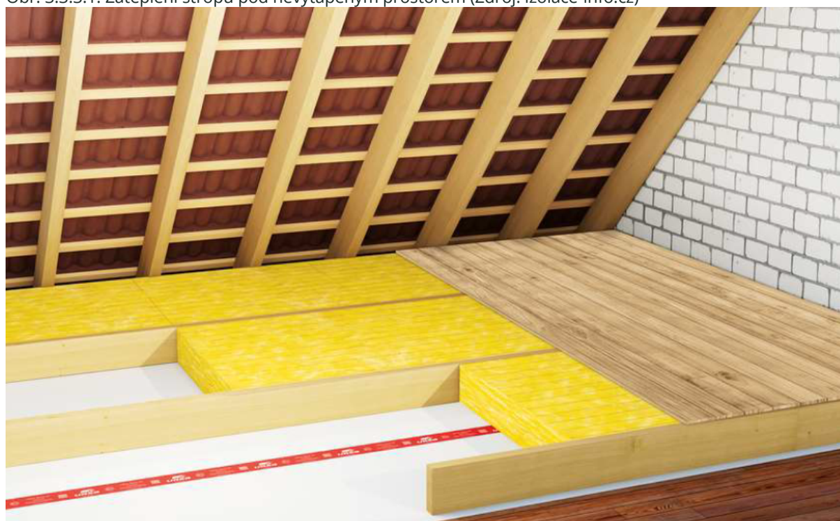
Obr. 3.3.3.1: Zateplení stropu pod nevytápěným prostorem (Zdroj: izolace-info.cz)
