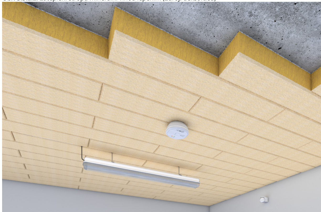
Obr. 3.3.2.2: Zateplení stropu minerální vlnou lepením (Zdroj: deksoft.eu)
